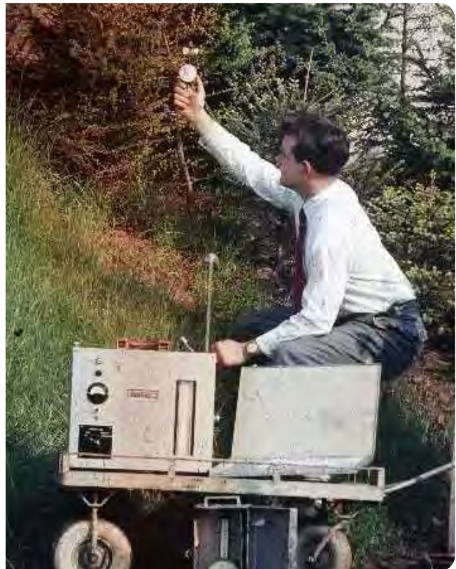
Messgerät zur Bestimmung des Schwefeldioxidgehalts in der Luft: der sog. Stratmann-Koffer, 1954 von Heinrich Stratmann, später Direktor der Landesanstalt für Immissionsschutz, entwickelt
