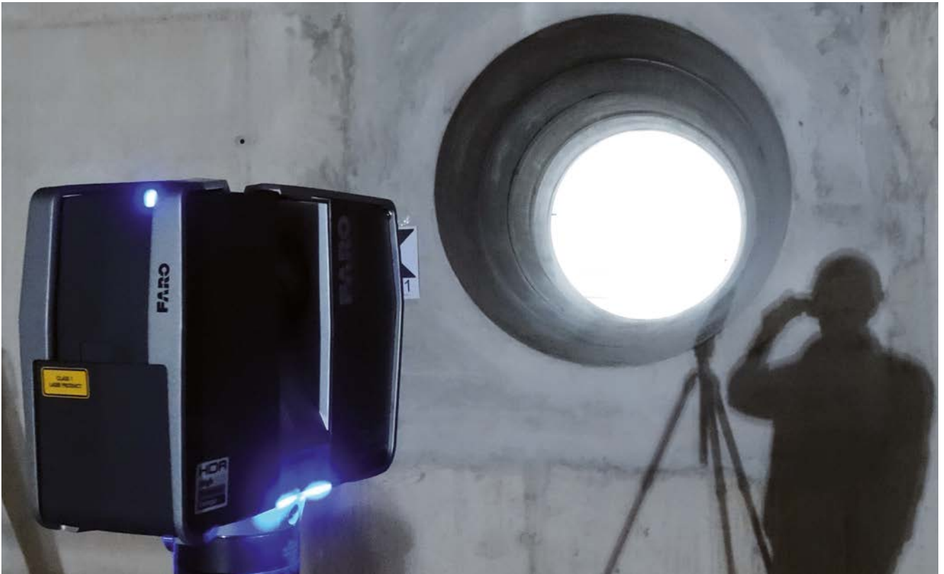
Erzeugung eines virtuellen Bauwerksmodells am Beispiel eines realisierten Bauvorhabens. Erster Schritt: Aufnahme von räumlichen Strukturen mit Hilfe eines Laserscanners.
