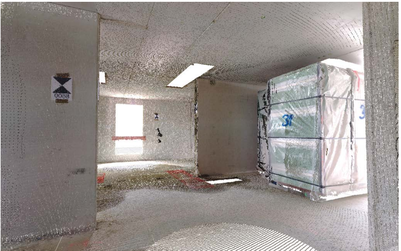
Zweiter Schritt: Erzeugung einer Punktwolke durch digitale Aufbereitung der gescannten/aufgenommenen Informationen.
